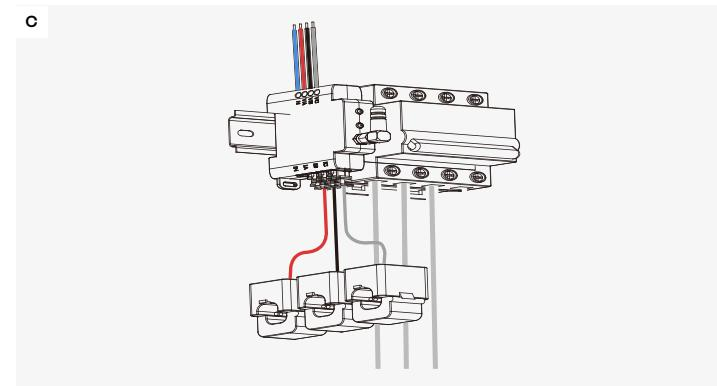
Schritt 2: Klemmen Sie jeden CT an das richtige Hauptstromversorgungs-Kabel auf der Seite des Stromzählers. Stellen Sie sicher, dass A am Phase-A-Kabel und CT B am Phase-B-Kabel befestigt ist. Achten Sie darauf, dass die Richtung des Pfeils auf dem CT in Übereinstimmung mit der Richtung des Stromversorgungsstroms zeigt. (Abbildung D)
